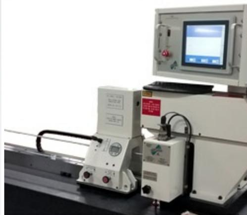
Dieses spezielle Steigungsgenauigkeits-Messgerät für Miniaturspindeln wurde von Thomson entwickelt. Es misst die vollständige Hublänge einer Spindel und bestimmt die Genauigkeit gemäß internationaler Normen.
