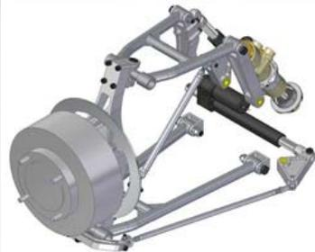
Ein modifizierter Thomson-Aktuator verhält zu einem extrem dynamischen System, das ohne die Gefahr von Überhitzung die zweifache Verstellkraft seines Vorgängers und ein höheres Ansprechverhalten lieferte.
