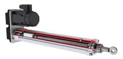
Das Design eines Präzisions Linearaktuatorens ist recht einfach. Ein Elektromotor – durch ein Riemengetriebe, Schneckengetriebe, Planetengeriebe oder direkt über eine Kupplung – dreht eine Kugelgewindespindel, welche den Drehmoment durch das Verlängerungsrohr in eine Axialkraft übersetzt.
