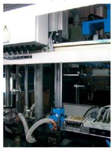
Präzisions Linearaktuatoren sind für chemische Anlagen, Papierfabriken, Schweiß- und Außenanwendungen geeignet. Dank des IP65 Schutzes, des robusten Designs und der Verwendung von hochwertigen Komponenten sind sie für fast alle Standorte geeignet.
